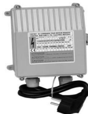
Echipament de protecție și control utilizat pentru pompele submersibile cu motoare monofazate. Dispune de un condensator de pornire și de protecție termică pentru a proteja motorul de efectele suprasarcinii.
